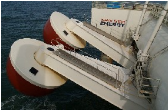
Effekten pr. flyder er fra min. 25 og op til 50 kW, ved en 2,5 meter signifikant bølgehøjde.
