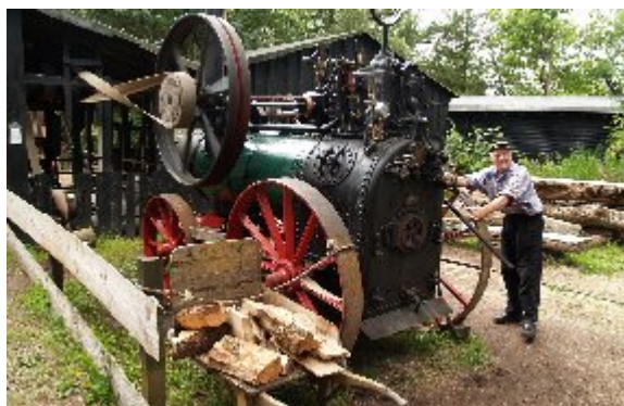
Dampsavværkets lokomobil, fra 1911, har været anvendt som trækraft for både tærskværk, tørvepresser og savværk.
